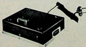
Het als onderzet-unit uitgevoerde voedingsdeel
